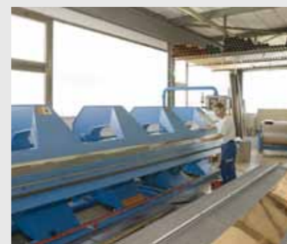
Pliage des tôles à la machine Les tôles sont amenées à la bonne forme au moyen de la plieuse (plieuse à main ou assistée par ordinateur). Les professionnels respectent les normes de sécurité.
